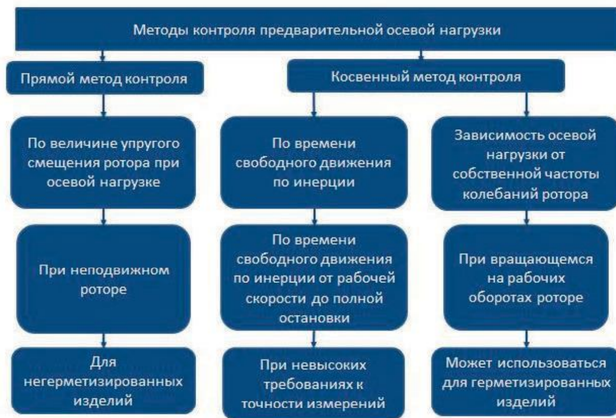
Рис. 1. Методы контроля предварительной осевой нагрузки
