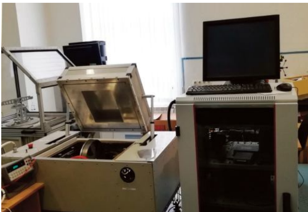
Рис. 5. Опытный образец стенда контроля осевой нагрузки СКОН
